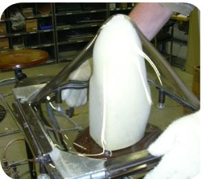
Cubra con cinta adhesiva el orificio en el Adaptador de 4-Agujeros. Cubra con cinta adhesiva cualquier orificio en el encaje.
