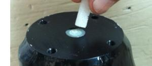
Si está utilizando el encaje en la prótesis definitiva, aplique Adhesivo de Tornillos Loctite 242 (o su equivalente) a los tornillos, y enrosque los tornillos a 9 pies-libras (12 Nm).
