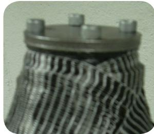
Aplique la capa siguiente. Ate el espacio entre la placa de formación y el Adaptador de 4-Agujeros. Termine de colocar la capa. Lamine.
